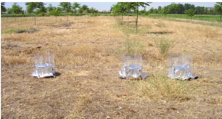
Figuras 7-10. Colocación del recipiente con álcali sobre el trípode, situar encima las cubetas forradas, cubrir con papel de aluminio, rodear con una maya metálica
