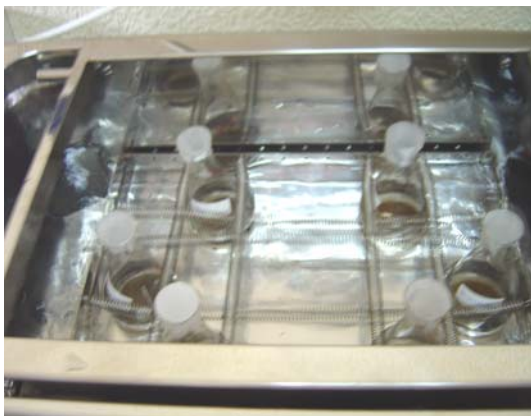
Figura 13. La muestra incubándose en el baño de incubación con vaivén
